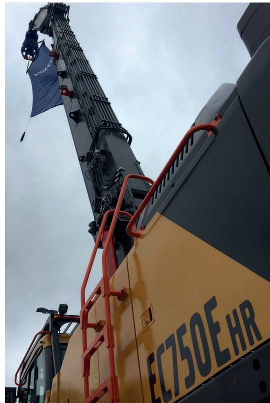
Les configurations d'équipements sont multiples et variées (pied, flèches, rallonges, balancier) pour obtenir une combinaison parfaite sur site. Les pelles sont quasiment toutes munies d'une trains de chaînes à voie variable, à l'exception d'une Sennebogen sur roues.
