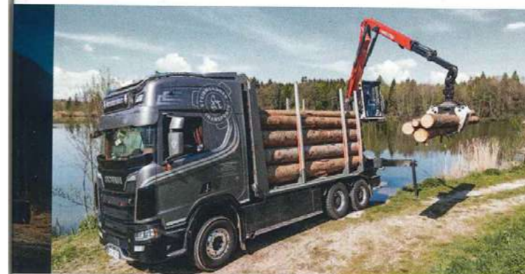
Les capacités de levage des grues Z et L Génération 3 affichent des capacités de levage comprises entre 10 et 18 tonnes métriques.
