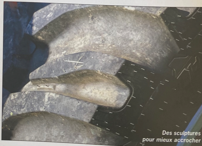
Un pneu radial intégrant une carcasse renforcée
