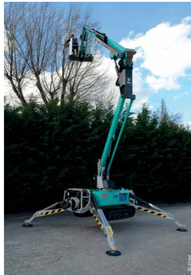
Proposée par Imer, la nacelle IM R 19 permet aux élagueurs de travailler jusqu'à 19 m de haut. Ses 4 stabilisateurs, équipés de patins de 350 mm de diamètre, sont automatiques.
